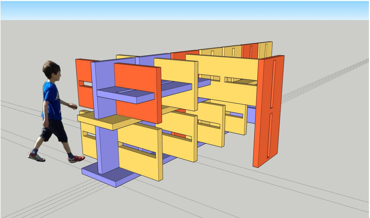
Das Bild zeigt eine mehr bausteinhaftes System. Die Elemente sind jetzt keine dünnen Flächen mehr, sondern dreidimensionale Körper. Für eine Umsetzung müssen mögliche Materialien auf ihre Eignung hin untersucht werden, um geringes Gewicht und Haltbarkeit in Einklang zu bringen.
